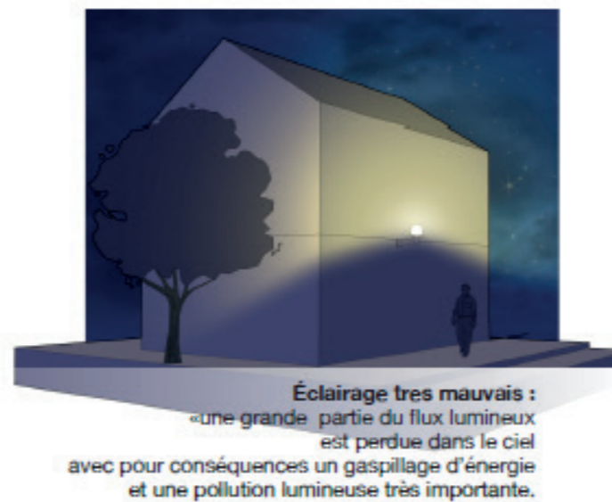
Figure 39 : Schéma d'orientations des dispositifs lumineux
